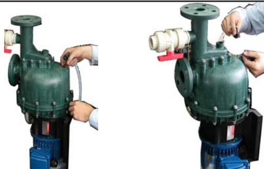
3、將 HC 合金線約 12 公分長雙股，在循環管接頭處繞兩圈，然後依絞麻花方式轉緊合金線，至固定後手指微微用力，至扳不動合金線為原則
